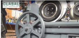
7) Установите приводные ремни (со второго прилагаемого набора) на шкивы насоса и электродвигатель
