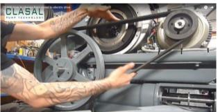
8) Переместите пластину с двигателями, затяните натяжение ремня и предварительно затяните болты натяжения ремня
