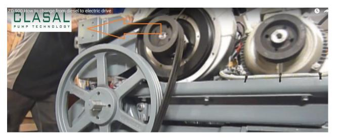
4) Снимите приводные ремни двигателя внутреннего сгорания
